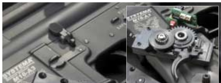
ギアBOX全体の減速比は既存の電動ガンより約4割低い。つまりローギアード設計になっている。
